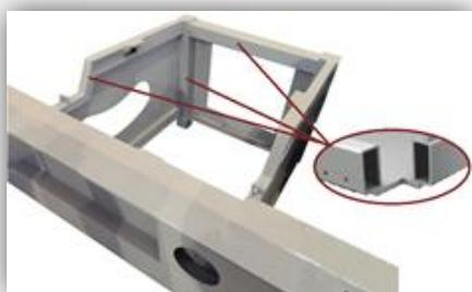
Каждый форматно-раскroечный станок ALTESA серии "P-45" имеет преимущества не только видимые, но и скрытые. Одним из таких преимуществ является мощная и надежная конструкция станины, которая выполнена из толстого листового металла в сочетании с жестким каркасом из закрытого квадратного профиля надежно гасит вибрации и обеспечивает еще больше стабильности.
