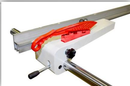
Цельнолитая конструкция крепления линейки, полностью исключает перекося и люфт при работе. А при помощи быстрого фиксатора скорость перенастройки составляет считанные секунды. Наличие миллиметрового доводчика позволяет оператору быстро выставить размер с высокой точностью.
