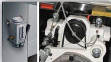
Все станки Р-45 компании ALTESA оснащены централизованной смазкой основных узлов и механизмов при помощи ручной помпы. Это позволяет снизить время на обслуживание станка, облегчить работу оператора, и увеличить долговечность узлов и механизмов. Оператору достаточно 1 раз в смену перед началом работы
