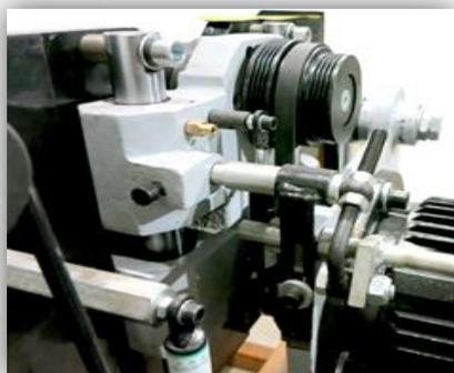
Пильный блок – является третьим наиболее важным преимуществом станков серии P-45. Точность линейных перемещений агрегата обеспечивают цилиндрические направляющие опоры. Благодаря поворотным сегментам,двигающимся по направляющим пазам, обеспечивается точность позиционирования угла наклона пильного диска.
